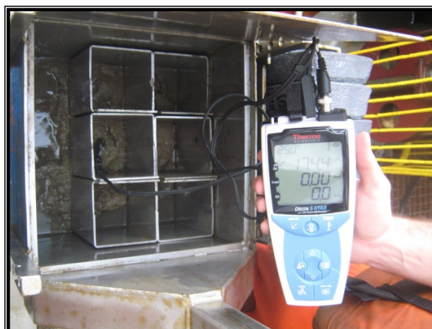
Figura VI.4.6-1 - Medição de potencial redox in situ com auxílio de um pHmetro.
