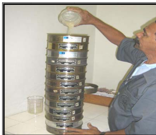
Figura VI.5.2-1 - A – Pesagem da alíquota de 30 g; B – Peneiramento da amostra em conjunto de peneiras de-2 fi a 4 fi.
