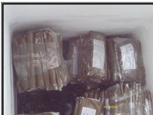
Figura VI.4.6-4 - A – Estratificação das amostras destinadas a análise de matéria orgânica total e carbono orgânico total; B – Armazenamento das amostras em sacos plásticos e sob congelamento.
