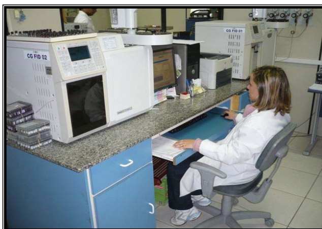
Figura VI.5.1.4 -1- Análise de n-alcenos utilizando o CG-FID.
