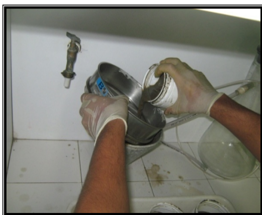
Figura VI.5.4.1-1 - A – Retirada do formol das amostras em capela com exaustão.; B – Utilização de EPI durante o tratamento das amostras.
