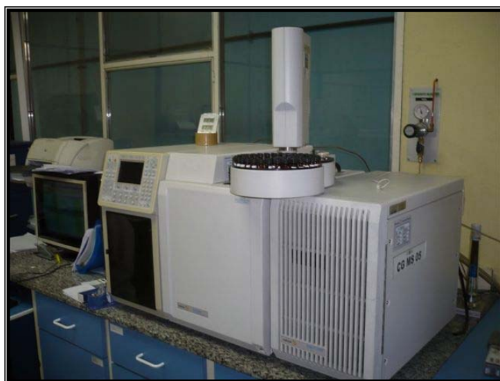
Figura VI.5.1.2-1 - Análise de HPA utilizando o CG-MS.
