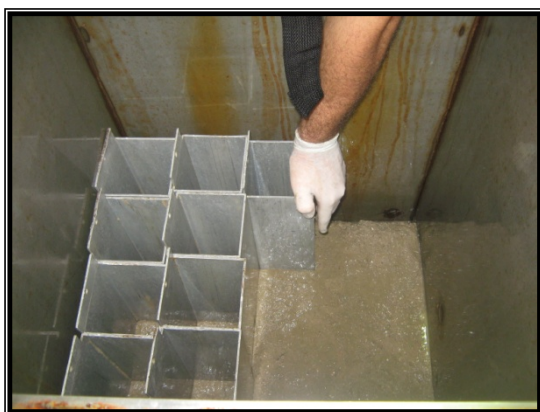
Figura VI.4.5-4 - A – Colocação dos testemunhos e gabaritos na amostra; B – Processo de estratificação das amostras.
