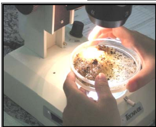
Figura VI.5.4.2-1 - A – Vista geral do laboratório; B – Procedimento de triagem com microscópio estereoscópico; C – Separação dos organismos por táxon.
