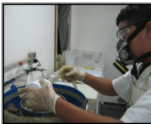
Figura VI.5.4.1-1 - A – Retirada do formol das amostras em capela com exaustão.; B – Utilização de EPI durante o tratamento das amostras.
