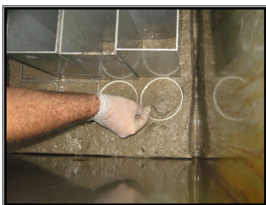
Figura VI.4.6-2 - A – Coleta de sedimento para análise de metais; B – Acondicionamento da amostra em sacos plásticos.
