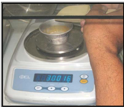
Figura VI.5.2-1 - A – Pesagem da alíquota de 30 g; B – Peneiramento da amostra em conjunto de peneiras de-2 fi a 4 fi.
