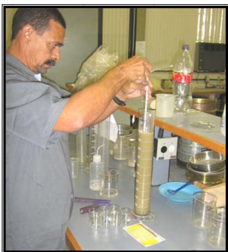
Figura VI.5.2-2 - A – Pipetagem da fração fina; B – Pesagem das diferentes frações do sedimento.
