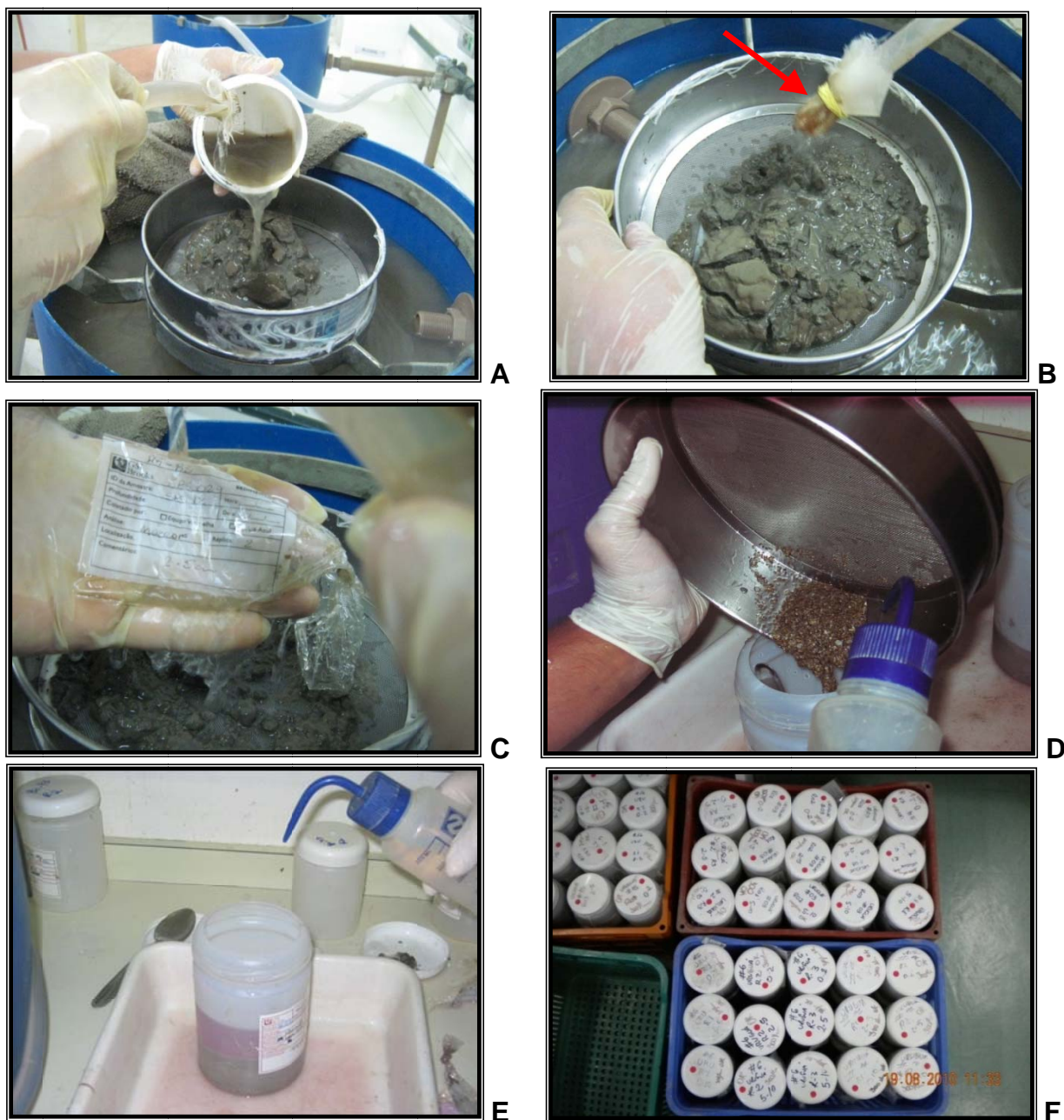
Figura VI.5.4.1-2 - A – Retirada das amostras dos potes; B – Retirada dos sedimentos finos com água filtrada em malha de 0,3 mm; C – Conferência com a etiqueta interna; D – Colocação do material retido nas peneiras em potes; E – Fixação da amostra; F – Identificação nos potes por malha e cores.
