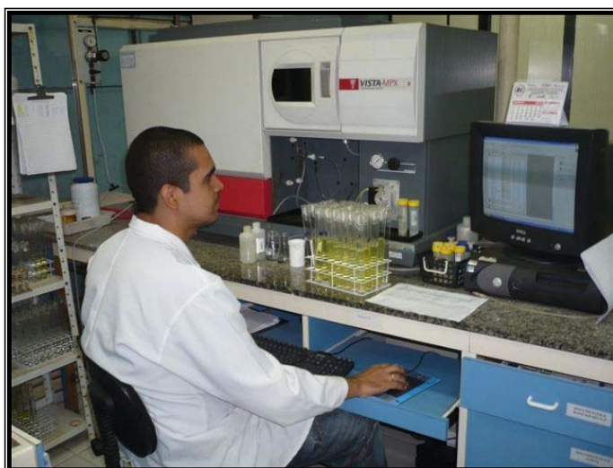
Figura VI.5.1.1 - Análise de metais utilizando o ICP-OES.
