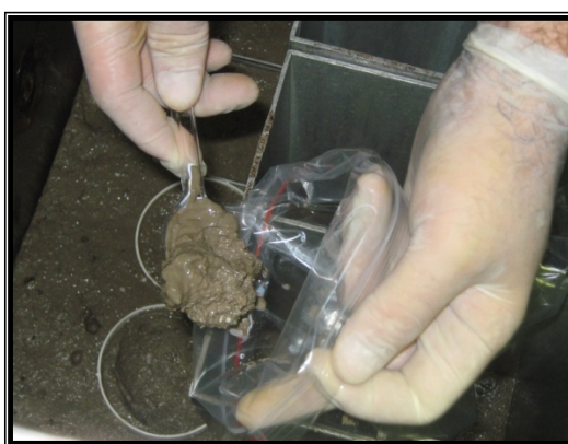
Figura VI.4.6-2 - A – Coleta de sedimento para análise de metais; B – Acondicionamento da amostra em sacos plásticos.
